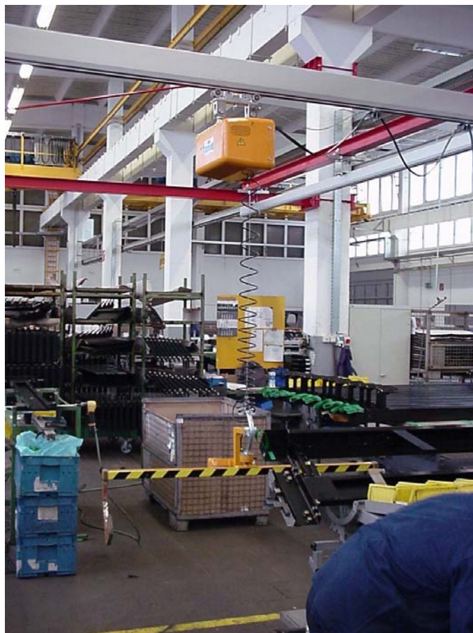
Alu-Deckenkran mit Elektrobaler KROMATIC®
