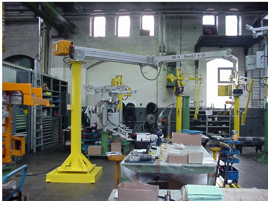
Knickschwenkarm für maximale Beweglichkeit mit Elektrobalancer KROMATIC®
